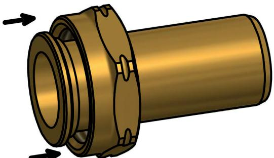
5) Vložit teles. vložku MMS504 s maticí MMU374 č. 2 do těla MMS531.
