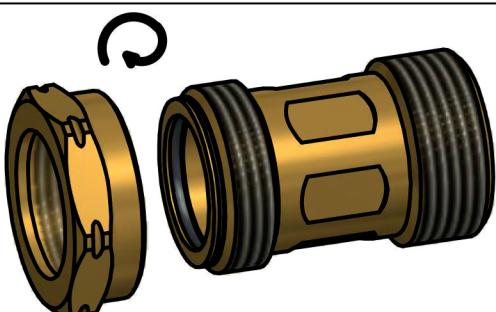
4) Vložit teleskopickou vložku MMS504 do matice MMU374I č. 2.
